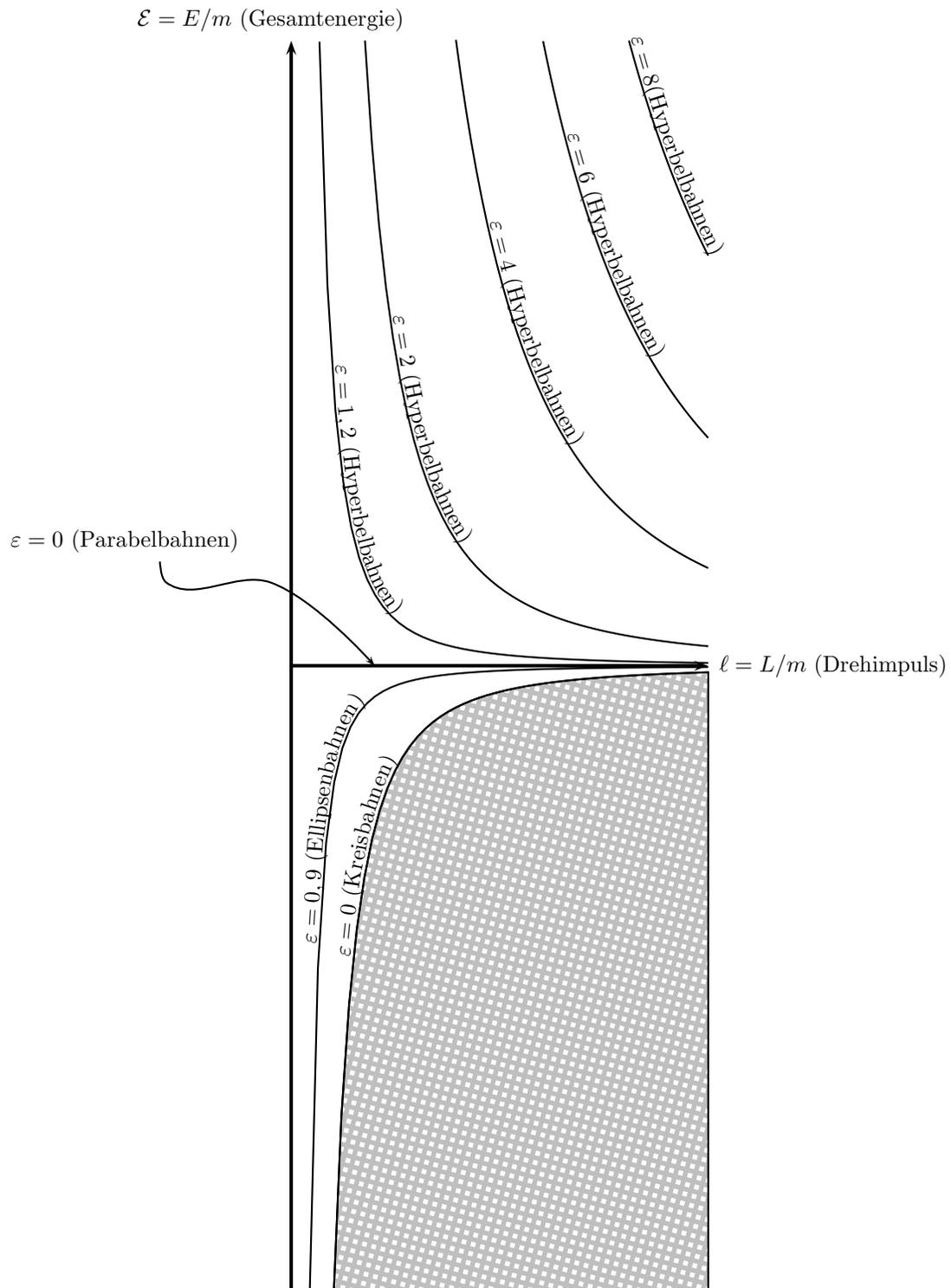
Abbildung 4: Das “Phasendiagramm” des Zweikörperproblems. In Abhängigkeit von Drehimpuls und Gesamtenergie kann die Bahnkurve unterschiedliche Formen annehmen. Die Form wird durch die Exzentrizität  $\varepsilon$  bestimmt. Es gilt immer  $\mathcal{E}\ell^2 \geq -G^2M^2/2$ , deshalb können die Punkte im markierten Bereich nicht auftreten.
