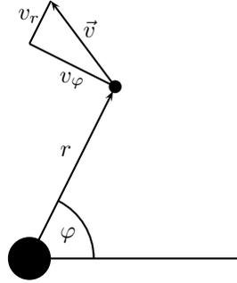
Abbildung 3: Polarkoordinaten für das Zweikörperproblem. Das Dreieck zeigt die Zerlegung des Geschwindigkeitsvektors  $\vec{v}$  in die Radialkomponente  $v_r$  und die Tangentialkomponente  $v_\varphi$ .
